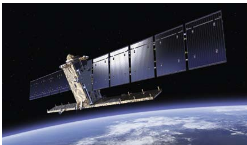
Sentinel-1 divu satelītu konstelācija izmaksā vairākus simtus miljonu eiro; katra satelīta masa ir 2,3 tonnas.
